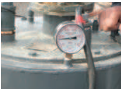
計測装置(例)：圧力計 (真空装置の圧力を計測)
